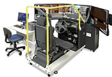
で行います。シミュレーターにはシートに移乗が安全にできるように台がついており、また手で操作するアクセル・ブレーキがついているため様々な障害に対して検査が可能です。具体的な検査の内容としては、主に①ハンドル旋回操作、②アクセル・ブレーキ踏み込み検査、③アクセル全開・急ブレーキの3項目で検査を行います。それぞれの検査はハンドルを一定のスピードで動かすことが可能な上肢筋力かどうか、アクセル・ブレーキを一定の力で動かすことが可能な上肢筋力・下肢筋力かどうか、アクセルからブレーキまでの切り替えのスピードを測定しています。また適性検査は四肢の動きだけではなく聴
